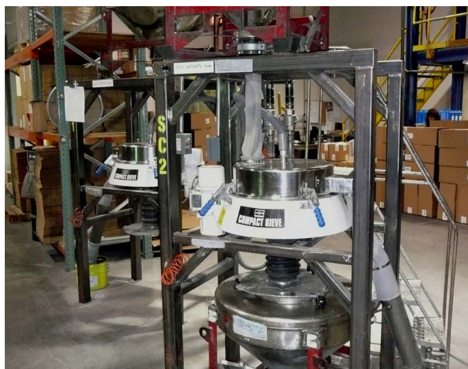
Figur 1. Russell Compact Sieves® installerad på DeloroStellite-anläggningen i Indiana.
